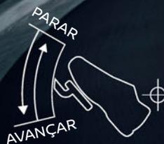
**e-Pedal.** Acelere, abrande e trave usando unicamente o pedal do acelerador. É tão simples.
