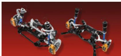
O comportamento é gerido por um sofisticado sistema de suspensão inteligente das 4 rodas, montado em subestruturas de alta precisão dianteiras e traseiras de 6 pontos. Um sistema especial de amortecedores Bilstein DampTronic regulável pelo condutor utiliza vários sistemas de informação do veículo para gerar as forças de amortecimento adequadas e um elevado nível de controlo para uma variedade de situações de condução.
