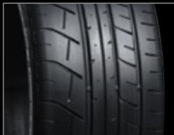
Até mesmos os pormenores de design dos pneus run-flat de alta performance Dunlop SP Desportivo MAXX GT600 DSST CTT que equipam o GTR são obsessivos: um pequeno bloco de borracha adicionado a um dos rastros diminui a torção do piso do pneu.
