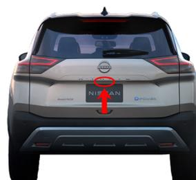
2. Desativação do sistema de alta tensão, usar as luvas de borracha isolante classe 0 ao usar este interruptor de corte
